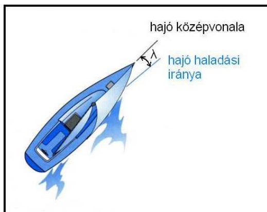
3.5. ábra: Vitorlás hajó sodródási szögének értelmezése [5]
