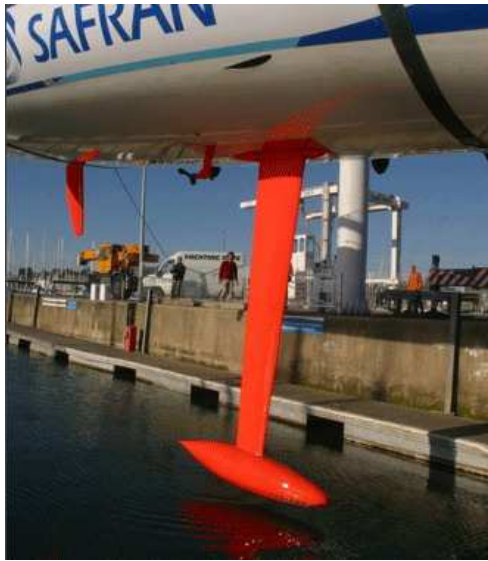
2.2. ábra: A Safran Open 60-as bulbás tőkesúlya [www.safransixty.com]
