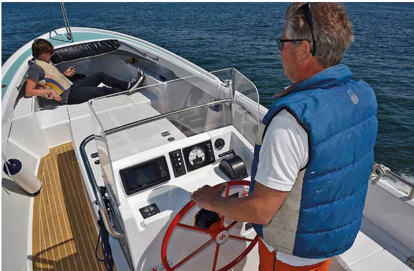
Förarplatsen är bekväm, trots att ratten är väldigt rak. På akterdäck finns nödstyrning om hydrauliken slutar att fungera.
